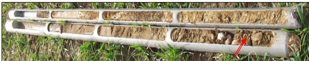
Abb. 3: Rammkernsonden „RKS 1“ mit „Terrassenschicht“ (unten: 0,00-2,00m; oben: 2,00-4,00m)
